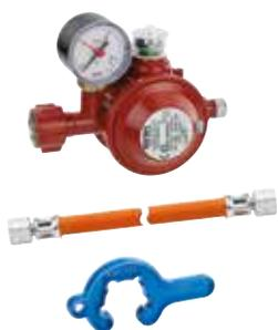
zum Anschluss an Gasflaschen, zur Druckregelung auf den Nenndruck des Gasgerätes bestehend aus: Niederdruckregler Typ EN61-DS mit Überdruck-Sicherheitseinrichtung S2SR (ÜDS), Sichtanzeige, thermischer Absperrereinrichtung „T“ (TAE), Manometer, Mitteldruck-Schlauch (Gummi mit Textileinlage; kältebeständig bis -30 °C; Schlauchabmessung 6,3 x 3,5 mm) G 1/4 LH-ÜM x G 1/4 LH-ÜM x 400 mm und MiniTool
