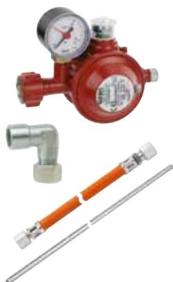
zum Anschluss an Gasflaschen, zur Druckregelung auf den Nenndruck des Gasgerätes bestehend aus: Niederdruckregler Typ EN61-DS mit Überdruck-Sicherheitseinrichtung S2SR (ÜDS), Sichtanzeige, thermischer Absperreinrichtung „T“ (TAE), Manometer, Mitteldruck-Schlauch (Gummi mit Textileinlage; kältebeständig bis -30 °C; Schlauchabmessung 6,3 x 3,5 mm) G 1/4 LH-ÜM x RVS 8 x 400 mm, Verbindungsrohr und Winkel-Aufschraubverschraubung Typ WAI IG G 1/2 x RVS 8
