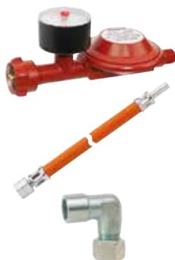
zum Anschluss an Gasflaschen, zur Druckregelung auf den Nenndruck des Gasgerätes bestehend aus: Niederdruckregler Typ EN61 mit thermischer Absperrrichtung „T“ (TAE), Manometer, Mitteldruck-Schlauch (Gummi mit Textileinlage; kältebeständig bis -30 °C; Schlauchabmessung 6,3 x 3,5 mm) G 1/4 LH-ÜM x RST 8 x 1000 mm und Winkel-Aufschraubverschraubung Typ WAI IG G 1/2 x RVS 8
