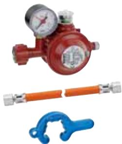
zum Anschluss an Gasflaschen, zur Druckregelung auf den Nenndruck des Gasgerätes bestehend aus: Niederdruckregler Typ EN61-DS mit Überdruck-Sicherheitseinrichtung S2SR (ÜDS), Sichtanzeige, thermischer Absperreinrichtung „T“ (TAE), Manometer, Mitteldruck-Schlauch (Gummi mit Textileinlage; kältebeständig bis -30 °C; Schlauchabmessung 6,3 x 3,5 mm) G 1/4 LH-ÜM x G 1/4 LH-ÜM x 400 mm und MiniTool
