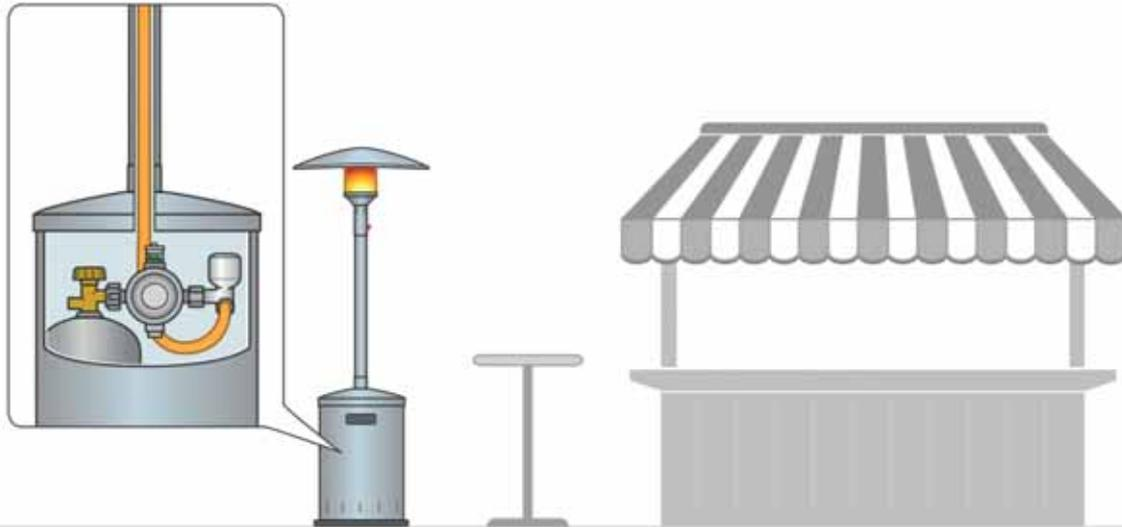
**Niederdruckregler mit integrierter Schlauchbruchsicherung EFV (SBS) für Kleinflaschenanlagen im Freien für den privaten bzw. gewerblichen Bereich**
