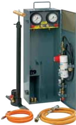
**Dicht- und Funktions-Prüfgerät**
